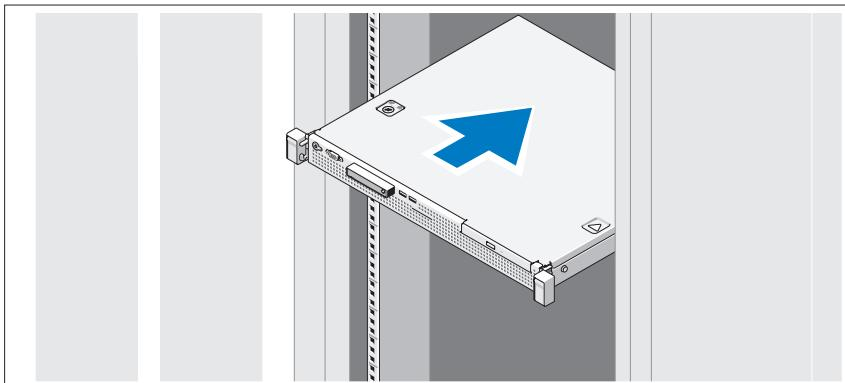
Zamontuj prowadnice i zainstaluj system w stojaku zgodnie z instrukcjami dotyczącymi bezpieczeństwa oraz instrukcjami dotyczącimi montowania systemów w stojaku dostarczonymi wraz z systemem.
