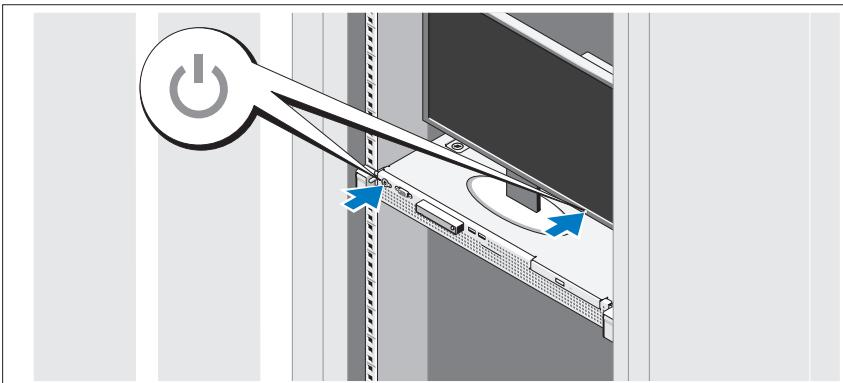
Stiskněte vypínač na systému a na monitoru. Indikátory napájení by se měly rozsvítit.
