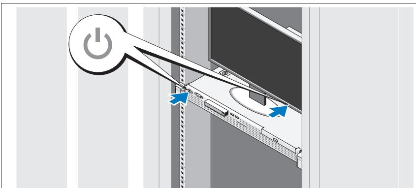
Drücken Sie den Netzschalter am System und am Bildschirm.
