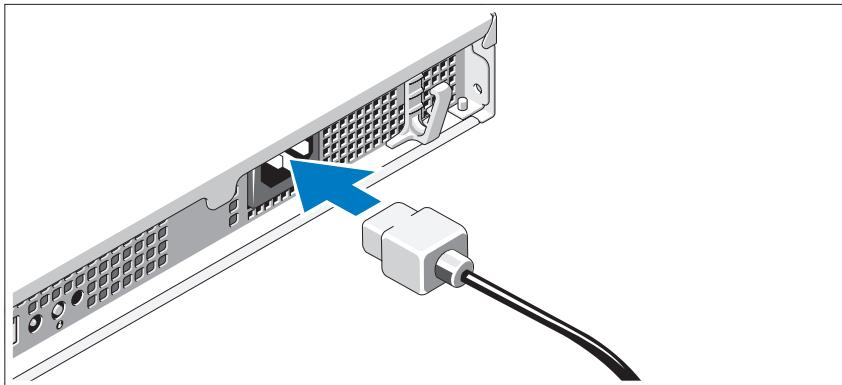
Συνδέστε το καλώδιο τροφοδοσίας του συστήματος στο σύστημα και, εάν χρησιμοποιείτε οθόνη, συνδέστε το καλώδιο τροφοδοσίας της οθόνης στην οθόνη.
