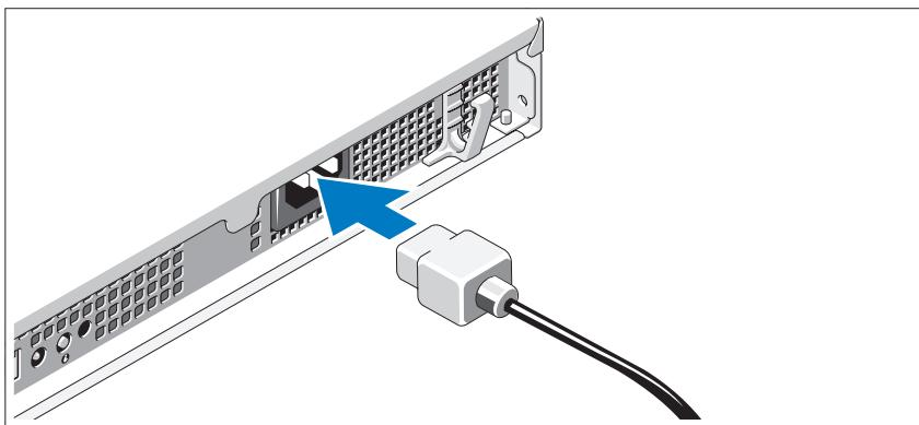
Sistemin güç kablosunun sisteme bağlantısını yapın ve bir monitör kullanılıyorsa monitörün güç kablosunun monitöre bağlantısını gerçekleştirin.
